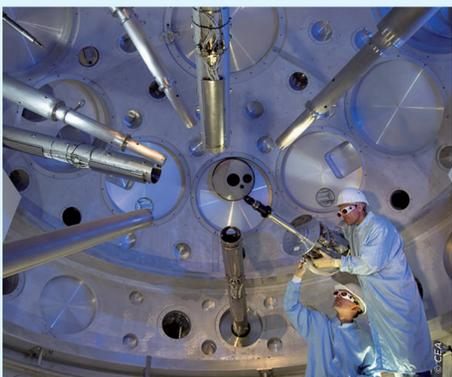
Vue de l'intérieur de la chambre d'expériences sous vide du LIL (Ligne d'intégration laser), mesurant 4,5 mètres de diamètre et pesant 17 tonnes. Dans cette chambre se trouvaient la cible et de nombreux instruments de mesure.
